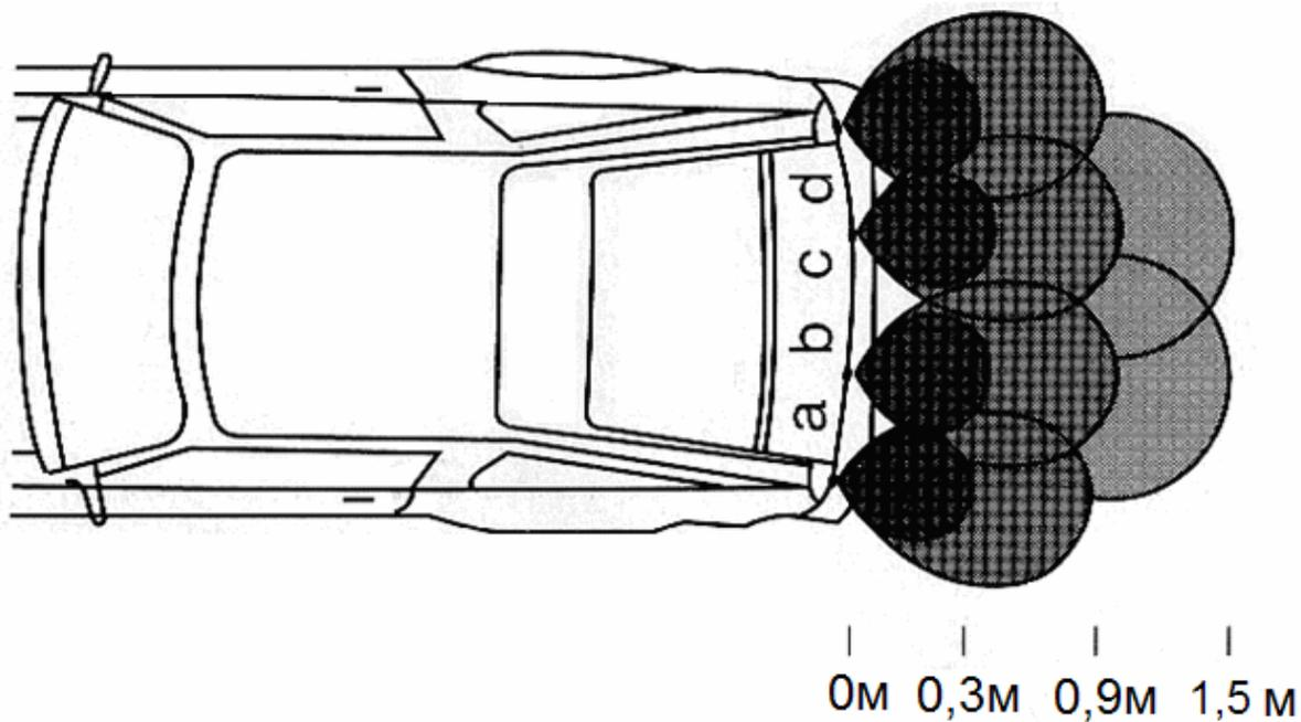
Причины, влияющие на точность определения расстояния от автомобиля до препятствия.
