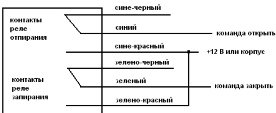
Схема подключения к системе запирания с положительным или отрицательным управлением
