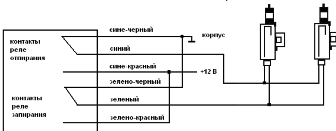
Схема подключения к двухпроводным приводам системы запирания
